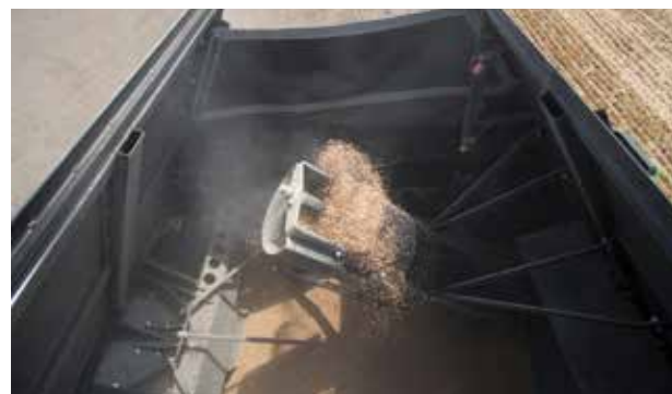
Capiente serbatoio con estensione con capacità di 9.500 l su tutte le versioni.
