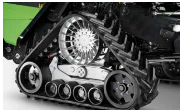
Cingolatura in gomma 30" per un minor compattamento e maggiore capacità di trazione.
