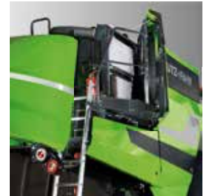
Tutti i radiatori sono apribili a libro e immediatamente esposti per la pulizia periodica.
