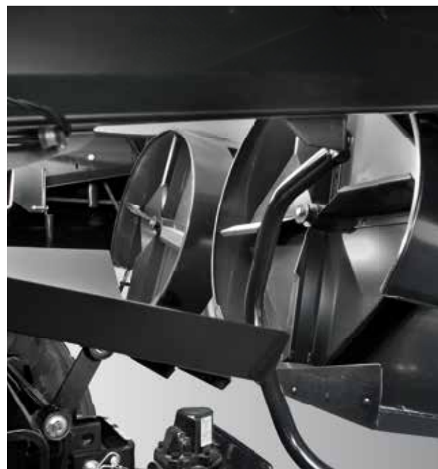
Spargi pula con nuovo convogliatore a scivoli metallici che indirizzano la pula verso i giranti a 4 pale.
