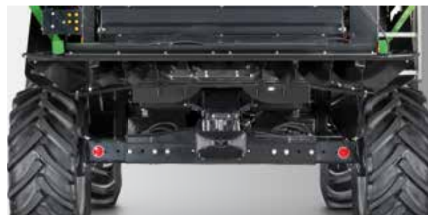
Dai riduttori ruote (con doppie tenute a labirinto) alla robusta struttura portante del nuovo assale posteriore registrabile e/o 4WD con l'affermato ed esclusivo sistema anti-skid
