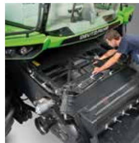
La piastra di copertura del canale di alimentazione, una volta rimossa, permette una facile ispezione e manutenzione alle catenarie e agli alberi.
